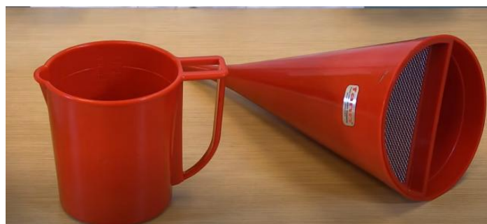
Figura 05 - Cuba para ensaio Marsh
